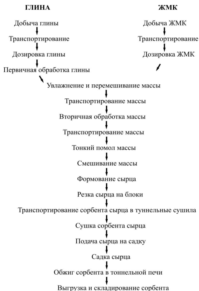
Рисунок 1 – Технологическая схема производства сорбента на основе ЖМК
