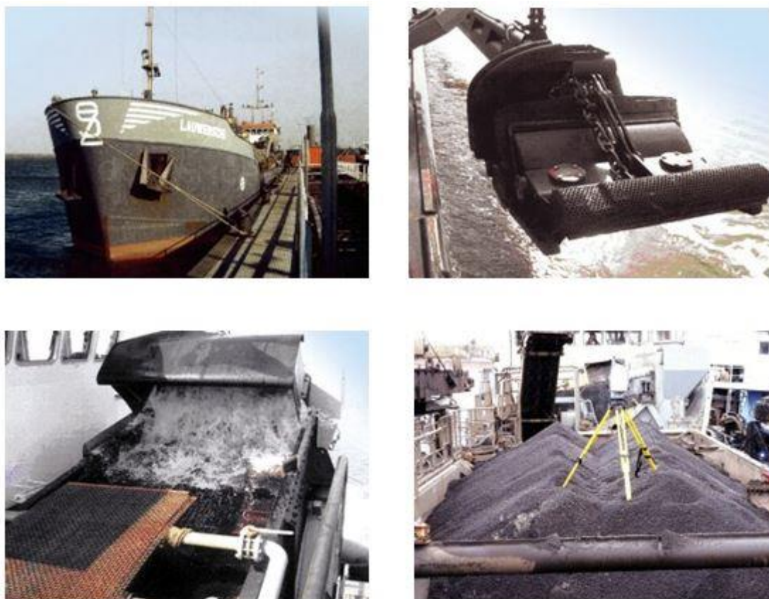
Рисунок 2 – Способ добычи ЖМК методом драгировки
